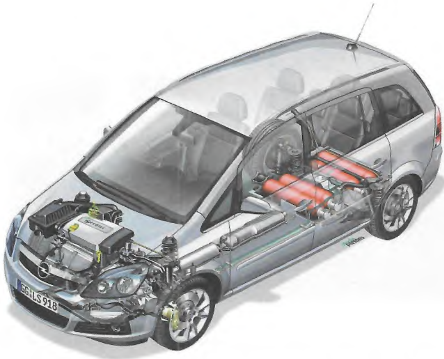
تصویری از نحوه استقرار و جاسازی مخازن در کف خودرو تولید کارخانه ای توسط شرکت OPEL مدل ZAFIRA
