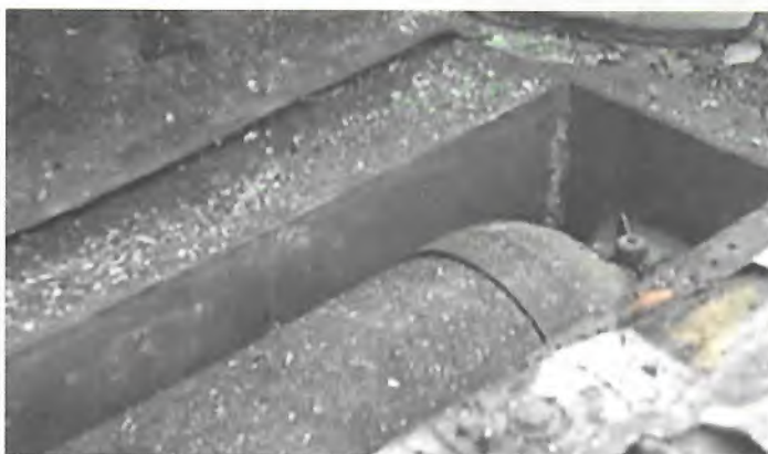
تصویر مخزن و شیر خودرو پس از خاتمه حریق
