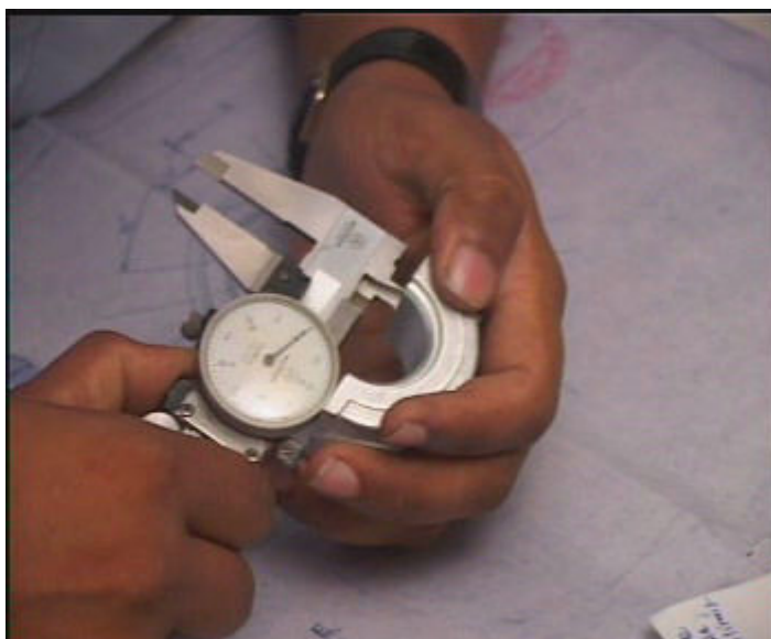
شکل ۱۵-۵: کنترل های ابعادی دستی در کارخانه VANAZ
