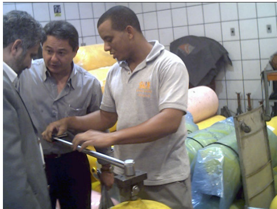
شکل ۱-۶: نصب شیر بر روی مخزن و به صورت دستی (یکی از کارگاه های تبدیل کشور برزیل)
