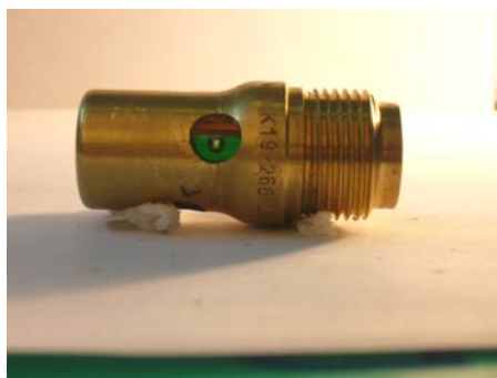
شکل ۱۷-۲: فیوز حرارتی از نوع حبابی در نمونه ای از شیرهای VTI
