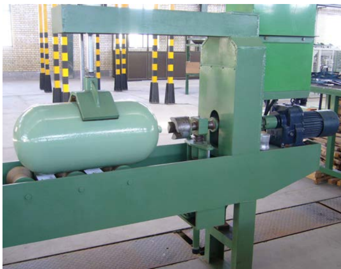
شکل ۳-۶: دستگاه اتوماتیک نصب شیر بر روی مخزن در کارخانه سانکا
