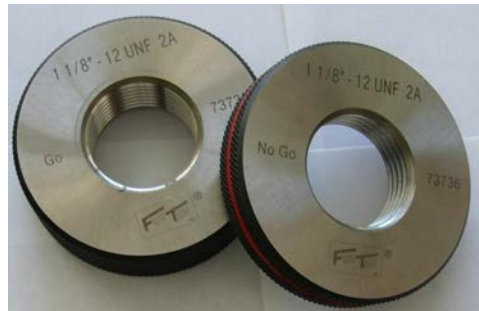
شکل ۹-۵: گیج برو-نرو برای کنترل رزوه اتصال به مخزن
