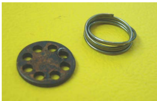
شکل ۴۶-۲: نمونه ای از فنرهای گره خورده در سیستم محدود کننده جریان
