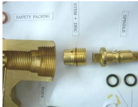
شکل ۵۸-۲: حفره مجرای بالانس فشار در مهره متحرک شیر Youngdo 2804
