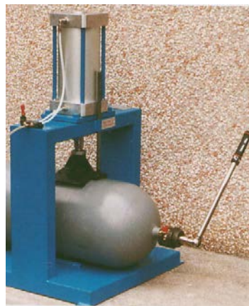
شکل ۲-۶: دستگاه های نیمه اتوماتیک برای نصب شیر بر روی مخزن
