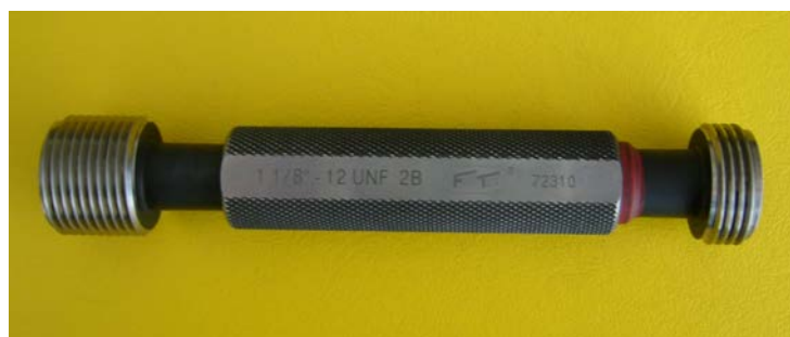
شکل ۱۱-۵: گیج برو - نرو برای کنترل رزوه به مخزن
