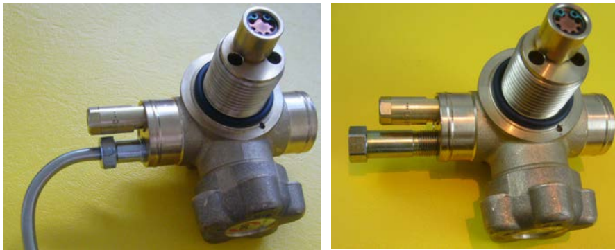
شکل ۲-۲: اتصالات جانبی شیر
