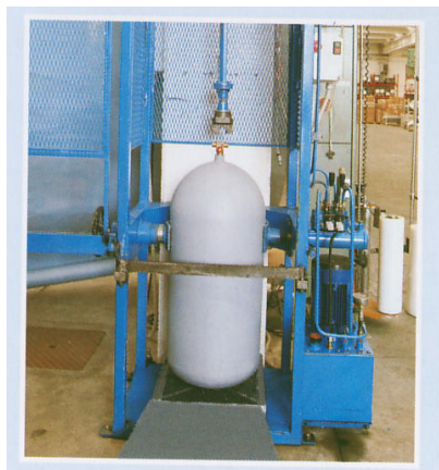
شکل ۲-۶: دستگاه های نیمه اتوماتیک برای نصب شیر بر روی مخزن
