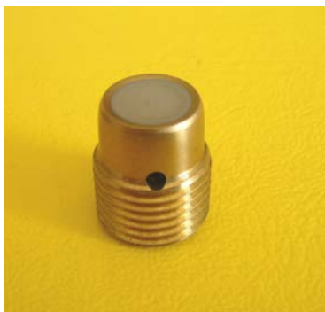
شکل ۵۵-۲: حفره مجرای بالانس فشار در مهره متحرک یک نمونه شیر VTI
