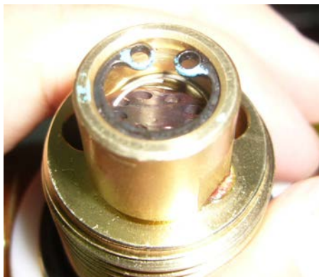
شکل ۲-۴۷: نمونه ای از فنرهای گره خورده در صفحه مدور سیستم محدود کننده جریان
