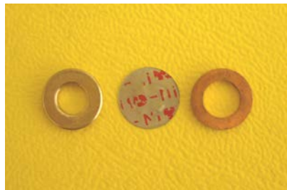
شکل ۴-۲۵: مونتاژ آزاد ورق شکننده ساده بین دو یا یک واشر
