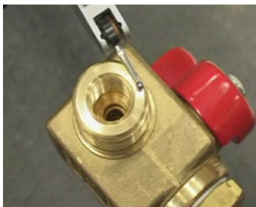
شکل ۱۴-۵: اندازه گیری توسط دستگاههای CMM
