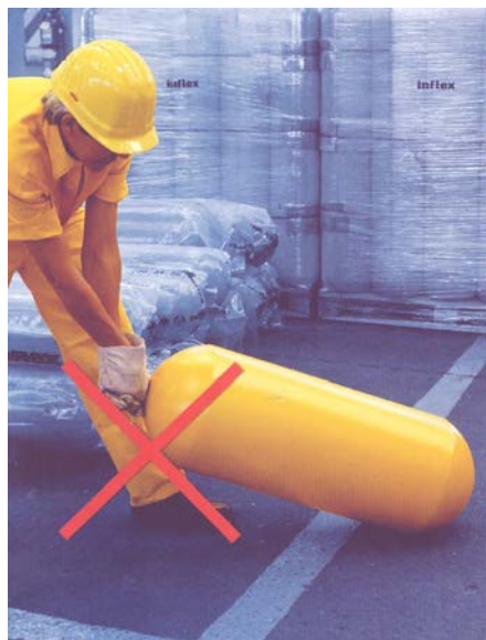
شکل ۲-۴: استفاده از شیر برای حمل و جابجایی مخزن
