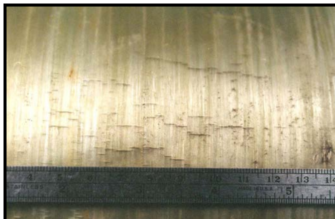
شکل ۱- مثالی از آسیب ترک خوردن ناشی از تنش و خوردگی در سیلندر کامپوزیت با الیاف شیشه‌ای
